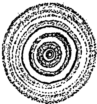
Рис. 5. Под электронным микроскопом видно, что срезы железных шариков, полученных карбонильным методом, имеют луковичное строение.
